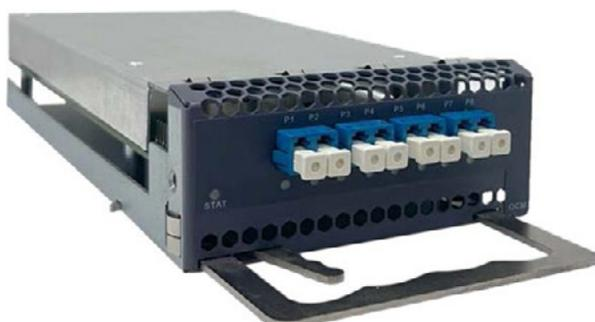
A placa OCM (Monitoramento de Canal Óptico) lançado pela Parks Communication é principalmente utilizado para analisar o desempenho do espectro do sinal MUX, potência óptica do canal, comprimento de onda e outros sinais de transmissão na faixa de comprimento de onda de 1528nm a 1567nm do sistema DWDM.
