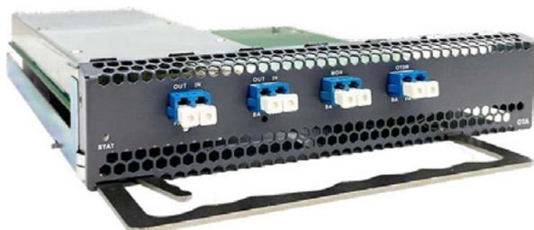
A principal função da placa OTA (Optical Terminal Amplifier) é compensar a potência óptica do sinal no link de transmissão. Ela pode amplificar simultaneamente os sinais ópticos de até 48 canais (espaçamento entre canais de 100 GHz) ou 96 canais (espaçamento entre canais de 50 GHz) na banda C. Possui as características de ganho plano, ganho ajustável, índice de baixo ruído, etc. Ao mesmo tempo, a placa possui canal de monitoramento óptico OSC integrado.
