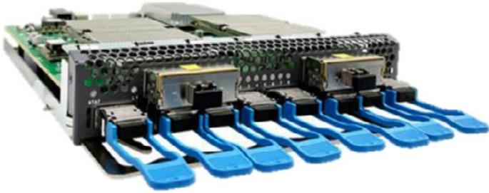
A placa de serviço Muxponder PK160 suporta o mapeamento de 8 x 100G recebidos no lado cliente em 2 x OTUC4 (400G). Além disso, realiza a interconversão entre sinais OTUC4 e sinais ópticos de comprimentos de onda WDM, conforme os padrões da ITU-T.
