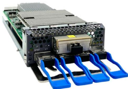
A placa de serviço Muxponder PK161 suporta o mapeamento de 4 x 100G recebidos no lado cliente em 1 x OTUC4 (400G). Além disso, realiza a interconversão entre sinais OTUC4 e sinais ópticos de comprimentos de onda WDM, conforme os padrões da ITU-T.
