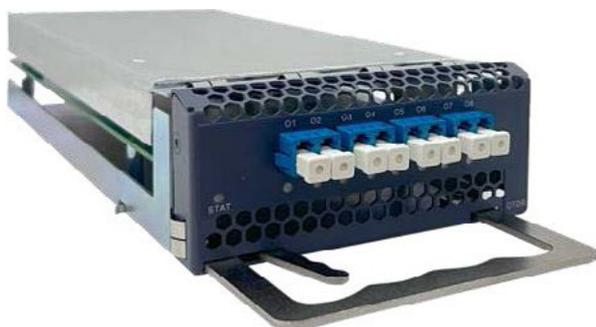
A placa de monitoramento de linha óptica (OTDR) lançada pela Parks Communication suporta o monitoramento de links de fibras ópticas de 8 núcleos, que é usado para transmitir luz de sonda, analisar a potência do sinal de detecção refletido pelo refletor óptico e realizar a localização de falhas e estatísticas de desempenho de linhas de fibra óptica. Com características notáveis de alta faixa dinâmica e alta resolução, é um dispositivo central essencial no sistema de transmissão óptica.
