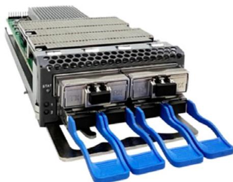
A placa de serviço Muxponder PK162 suporta o mapeamento de 4 x 100G recebidos no lado cliente em 2 x OTUC2 (200G). Além disso, realiza a interconversão entre sinais OTUC2 e sinais ópticos de comprimentos de onda WDM, conforme os padrões da ITU-T.
