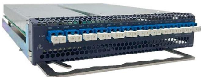
A placa ROADM (Roteador Óptico de Multiplexação por Divisão de Comprimento de Onda) de 9 dimensões lançado pela Parks Communication suporta a integração das funções-chave WSS, Ba, PA e OSC em um único cartão, possui componentes WSS duplos de 1x9 embutidos e dispõe de 9 portas para multiplexação e demultiplexação de comprimentos de onda.
