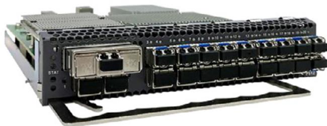
A placa de serviço Muxponder PK164 suporta o mapeamento 20 x 10G recebidos no lado cliente em 1 x OTUC2 (200G). Além disso, realiza a interconversão entre sinais OTUC2 e sinais ópticos de comprimentos de onda WDM, conforme os padrões da ITU-T.
