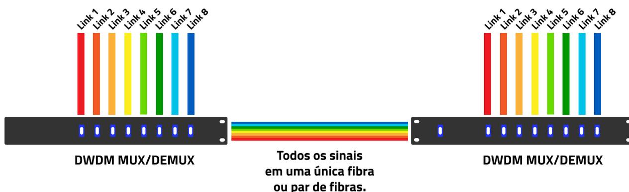
O DWDM multiplexa até 40 canais ópticos separados um do outro por 0,8nm (100 GHz) operando na banda C, atingindo uma taxa de transmissão de dados de 10 Gbps, por canal, totalizando até 400 Gbps. Existem também sistemas DWDM com espaçamento de 200, 50 ou até 25 GHz.
